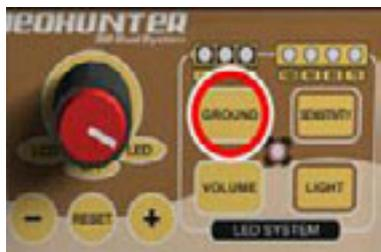
1. Чтобы выполнить отстройку от грунта, переключите устройство в режим светодиодной индикации (LED) и нажмите кнопку GROUND («ГРУНТ»).
