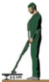
6. Если влияние грунта на устройство не наблюдается, индикация на полоске, изображенной на рисунке, отсутствует, и на дисплей выводится сообщение Ground Setting 100% Completed («Отстройка от грунта завершена на 100%»). В таком случае устройство готово к поиску, и можно переключиться в режим поиска (EXPLORE), нажав кнопку АССЕРТ.
