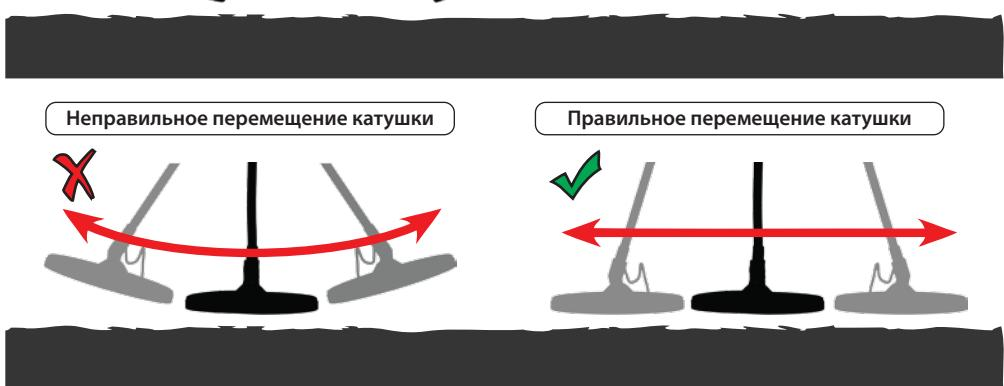
Для получения наиболее точных результатов важно, чтобы поисковая катушка располагалась параллельно поверхности земли.
