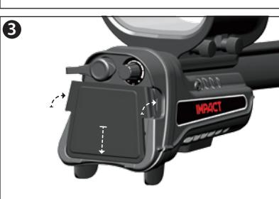
Крышку батарейного отсека поместить в направлении стрелки, показанной на изображении. Нажмите на петли, чтобы крышка щелчком зашла на место.
