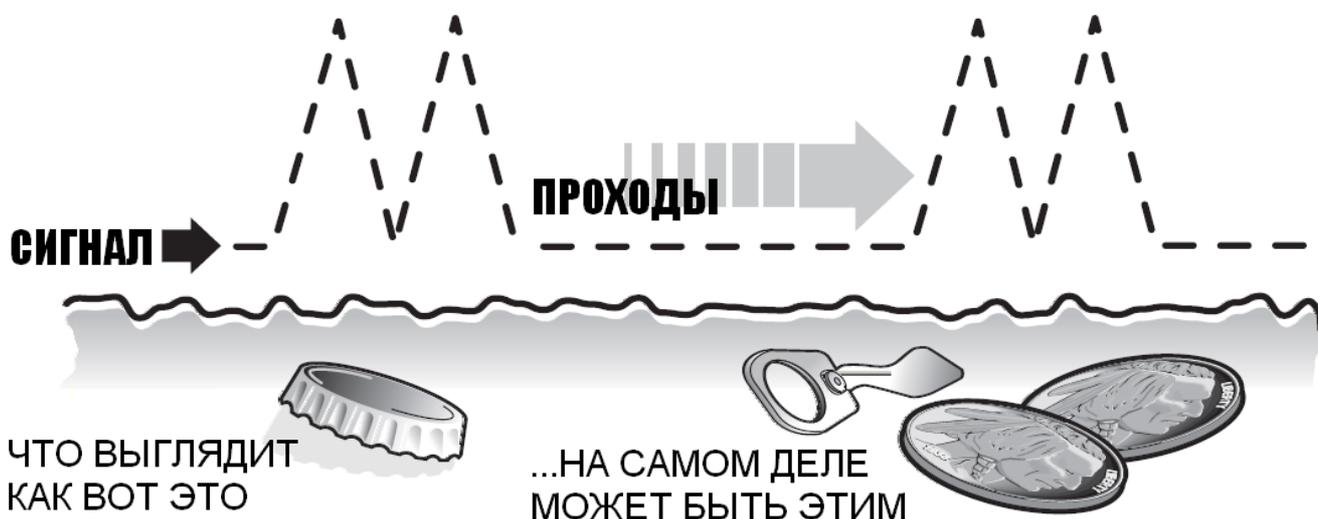
В ходе поиска вам встретятся ложные срабатывания. Ложные срабатывания – это звуковые сигналы, формируемые в отсутствие металлических объектов. Ложные сигналы могут возникать из-за воздействия электромагнитных помех, окисления или высокой минерализации почвы. Если вы услышали одиночный сигнал, но при повторных проходах над этим же местом сигналов нет, то, вероятнее всего, объекта здесь нет.
