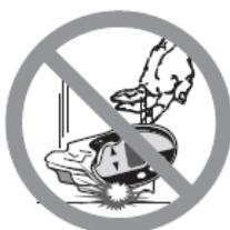
Следует использовать только свежие батарейки рекомендованного типа и размера. Старые батарейки могут течь, что может повредить электронные компоненты металлоискателя.
