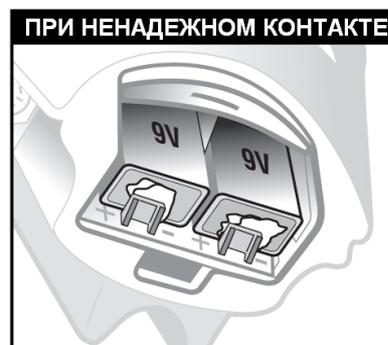
Большинство проблем с металлоискателями вызвано неправильно установленными батарейками или применению нещелочных или разрядившихся батареек. **Если металлоискатель не включается, проверьте элементы питания.**
