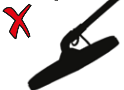
Неправильный угол наклона поисковой катушки
