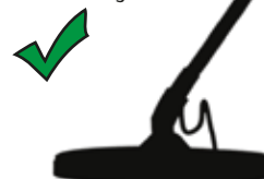
Правильный угол наклона поисковой катушки
