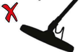
Неправильный угол наклона поисковой катушки
